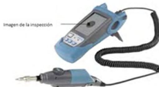
Dado que la ferrule (macho) del conector a inspeccionar se inserta en uno de los extremos del instrumento, y el usuario observa desde el otro extremo; los microscopios de fibra óptica no están diseñados para la comprobación de acopladores (hembra) situados en un panel.
