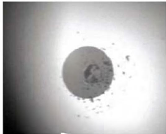
Conector de amplificador EDFA dañado permanentemente
